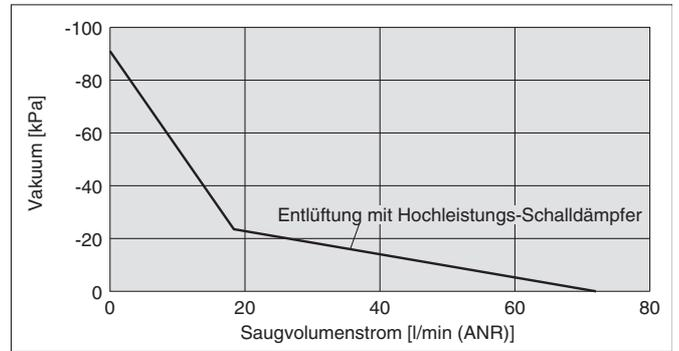
**ZK2** 15 \* Die nachfolgenden Grafiken zeigen die Kennlinien des Vakuumerzeugers mit Ventil. (Bitte setzen Sie sich für die Modelle ohne Ventil mit SMC in Verbindung.)
