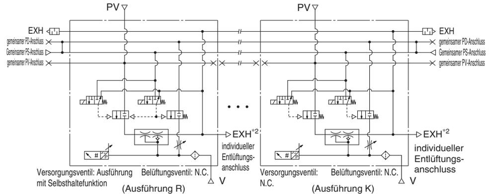
\*2 Bei der Ausführung mit gemeinsamer Entlüftung sind die einzelnen Stationen mit einem individuellen Entlüftungsanschluss ausgestattet.
