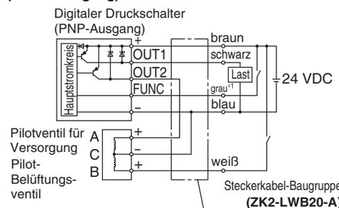
\*1 Der graue Draht (FUNC) wird angeschlossen, wenn der Betrieb des Versorgungsventils über eine Energiesparsteuerung verläuft (für Werkstück-Ansaugung). (Weitere Informationen finden Sie in der Betriebsanleitung für ZK2-ZSV□□□-A auf der SMC-Webseite.)
