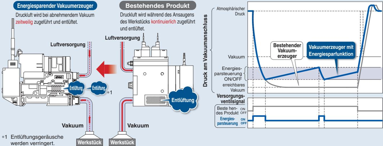
Reduzierung des Druckluftverbrauchs: **93 %**
