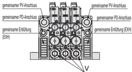
\*1 Die gemeinsame Entlüftung ist eine Methode, bei der die gemeinsame Entlüftung der Endplatte mit der direkten Entlüftung der einzelnen Stationen kombiniert wird.
