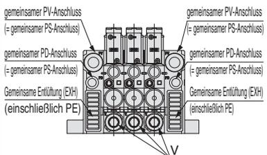
\*1 Die gemeinsame Entlüftung ist eine Methode, bei der die gemeinsame Entlüftung der Endplatte mit der direkten Entlüftung der einzelnen Stationen kombiniert wird.
