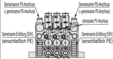
\*1 Die gemeinsame Entlüftung ist eine Methode, bei der die gemeinsame Entlüftung der Endplatte mit der direkten Entlüftung der einzelnen Stationen kombiniert wird.
