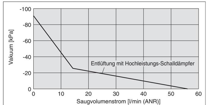
**Entlüftungs- und Durchflusskennlinien Vakuumerzeuger (repräsentative Werte)**
