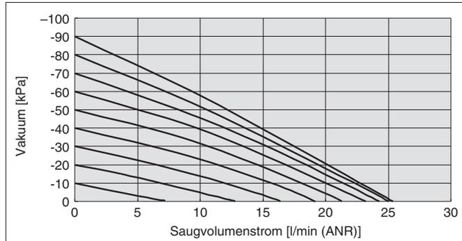
Der tatsächliche Saugvolumenstrom am Ansaugpunkt ist je nach Leitungsbedingungen an den Vakuumanschluss unterschiedlich. (Der Wert im obigen Diagramm gilt, wenn der V-Anschluss den Durchmesser Ø 8 hat.)
