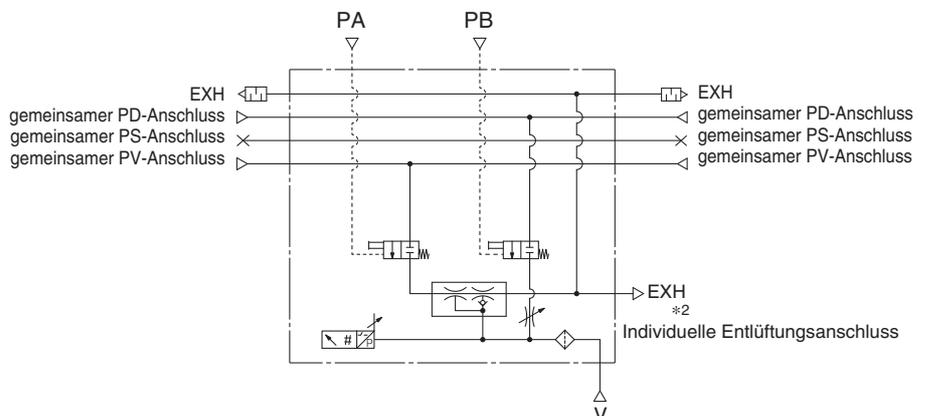
\*2 Bei der Ausführung mit gemeinsamer Entlüftung sind die einzelnen Stationen mit einem individuellen Entlüftungsanschluss ausgestattet.
