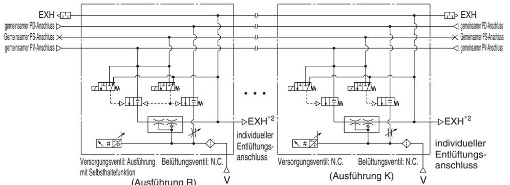
\*2 Bei der Ausführung mit gemeinsamer Entlüftung sind die einzelnen Stationen mit einem individuellen Entlüftungsanschluss ausgestattet.
